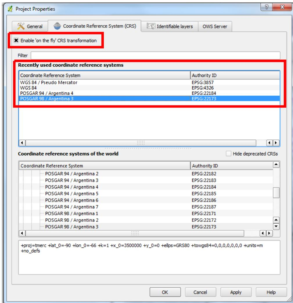
En caso de no tener “**POSGAR 98 / Argentina 3 - EPSG 22173**” en el recuadro de “**Recently used coordinate reference systems**” (**Sistemas de referencia de coordenadas usados recientemente**), usamos el recuadro de arriba **Filter (Filtrar)** e ingresamos “**22173**” que es el código EPSG para el
