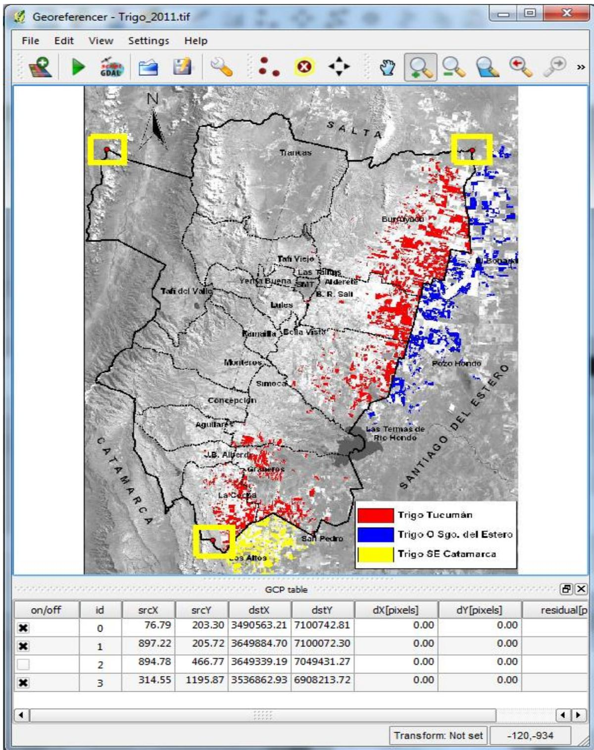
Como se puede observar he marcado 4 puntos, y descarté para la geo-referencia el punto ID=2, destilando la opción **ON/OFF**.
